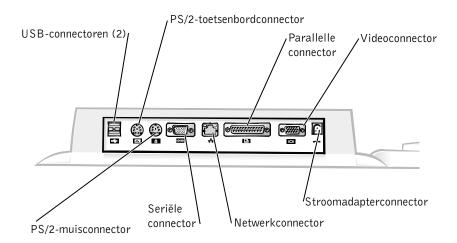
In de tabel "Externe I/O-connectoren" worden pictogrammen weergegeven voor de connectoren aan de achterzijde van de APR en het type extern apparaat dat op elke connector kan worden aangesloten.
