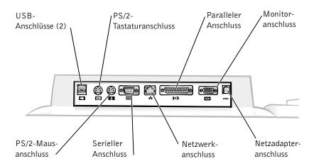
In der Tabelle "Externe E/A-Anschlüsse" sind die Symbole für jeden der Anschlüsse auf der Rückseite des APR aufgeführt. Außerdem wird angegeben, welche externen Geräte an jeden Anschluss angeschlossen werden können.
