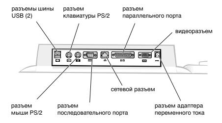
В таблице "Внешние разъемы ввода/вывода" приведены условные обозначения разъемов на задней панели повторителя портов APR и типы внешних устройств, которые могут быть подключены к каждому из этих разъемов.
