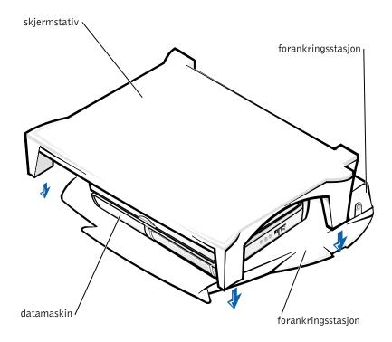
**OBS!** Kontroller at føttene bak på skjermstativet sitter i nedfellingene på hver side av forankringsstasjonen.
