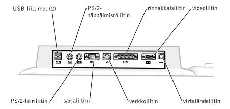
Ulkoiset tulo- ja lähtöliittimet -taulukossa on esitetty APR-laitteen takapaneelissa olevien liitinten symbolit sekä ne laitetyypit, joita kuhunkin liittimeen voidaan kytkeä.
