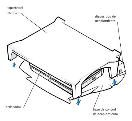
**NOTA:** Asegúrese de que las patas traseras del soporte del monitor encajan en las ranuras situadas a ambos lados de la base de control de acoplamiento.
