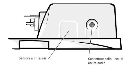
Controlli e indicatori della base dell'alloggiamento di espansione
