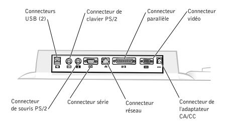
Le tableau « Connecteurs d'E/S externes » présente les icônes de chaque connecteur à l'arrière du réplicateur de port avancé et indique le type de périphérique externe pouvant être branché à chaque connecteur.
