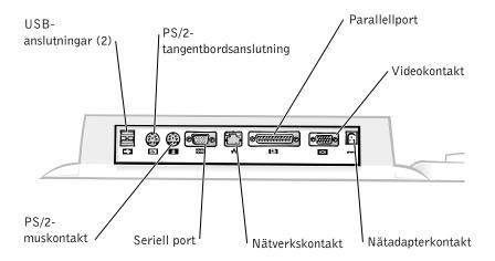
I tabellen Externa I/O-kontakter visas ikonerna för de olika kontakterna på portreplikatorns baksida och de typer av externa enheter som du kan ansluta till varje kontakt.
