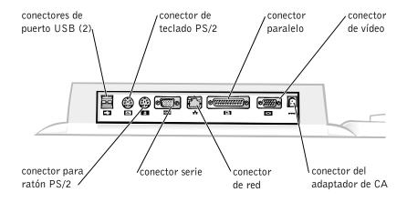
La tabla de Conectores E/S externos muestra los iconos de cada uno de los conectores situados en la parte posterior del APR e indica el tipo de los dispositivos externos que se pueden conectar a cada conector.
